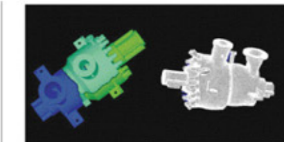
①:ポンプの固有値解析(311,580節点、1,368,583要素) 計算時間(Xeonクラスタ4PE):固有値2時間15分(30次まで)、後処理3時間(6分x30次)
